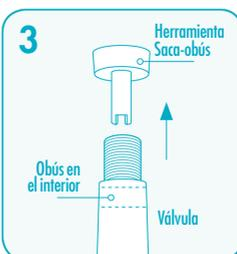
**3** Gira el neumático, coloca la válvula en la parte inferior y extrae el obús de su interior
