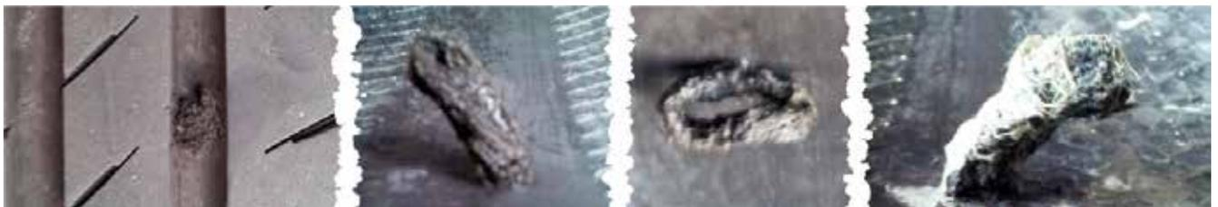
BlueShield49 no se puede utilizar en neumáticos que hayan sido reparados con el método de la seta o de las barritas obturadoras (conocidas como espárragos o macarrón). En las imágenes se puede observar como sobresale una gran porción en el interior del neumático. Con el giro del neumático, las fibras se irían agarrando al espárrago, con la consiguiente pérdida de efectividad e incluso causando un desequilibrado de la rueda.
